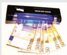
Fig. 19: Detector de bancnote false, cu radiație UV.
