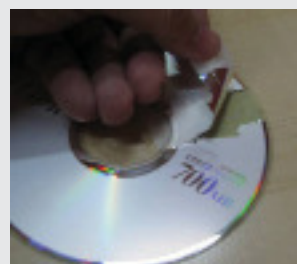
Fig. 3b: Îndepărtarea stratului metalic de pe CD cu ajutorul unei benzi adezive
