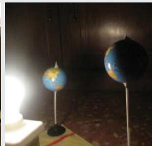
Fig. 4b: În poziția C este iarnă în emisfera nordică și Soarele este la 23,5^\circ sub ecuator. În emisfera sudică este vară.
