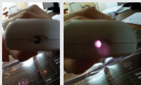
Fig. 10a Telecomanda activată privită cu ochiul liber. Fig. 10b Telecomanda activată, privită cu ajutorul camerei foto a mobilului
