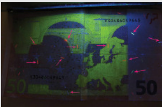
Fig. 18: O bancnotă de 50 € iluminată cu lumină UV
